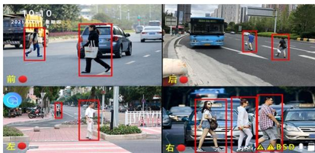
Conforme mostrado na figura acima, a página principal exibirá as imagens de quatro câmeras. Quando um cartão SD é inserido, o sistema entrará automaticamente no modo de gravação. Durante a gravação, o ponto vermelho piscará. Depois de ativar a detecção de pedestres, você pode escolher diferentes canais para pedestres, detecção de ponto cego e alarme, lembrar o motorista no carro e lembrar os pedestres fora do carro ao mesmo tempo.
